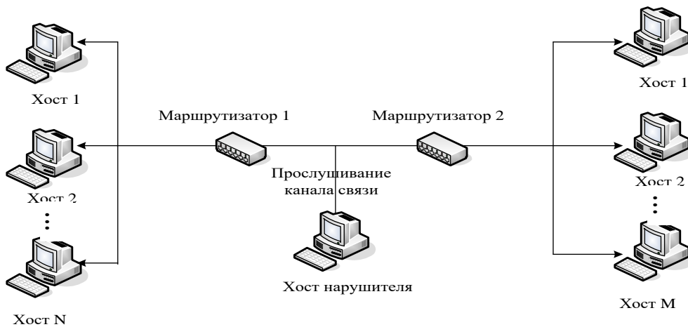
Рисунок 6. Схема реализации угрозы «Анализ сетевого трафика»
